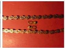
et vous démontez l'attache rapide. A l'heure actuelle, il est complètement inutile de continuer à sertir ses chaînes. Remplissez un bocal du liquide de nettoyage (pétrole et non mazout) et agitez
