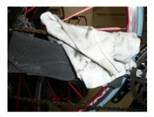
Huilez et non graissez au spray au Teflon® en utilisant un long couvercle de boîte en carton (ou assemblez 2 couvercles de cartons à chaussures) qui va vous protéger le pneu et la jante ainsi que le sol de votre atelier du jet gras. Laissez reposer quelques minutes et
