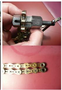
Montez la nouvelle en passant bien dans la fourchette du dérailleur avant, glissez-la sur un pignon et terminez en la coulissant dans le bon sens entre les roulette du dérailleur arrière, fermez l'attache rapide.
